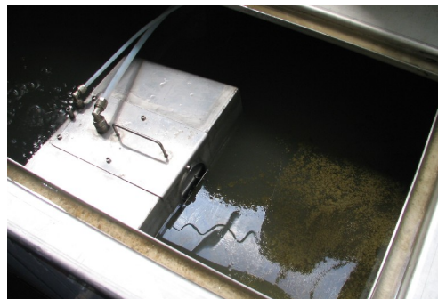
OGP 1 können in sehr kleinen Behältern oder sogar innerhalb anderer Anlagen arbeiten
