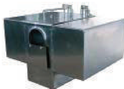
Rys. 1. Odolejacz grawitacyjny typu OGP 1 – konstrukcja objęta ochroną patentową. Pływak przedstawiony na zdjęciu (wymiary: 300 x 200 x 180 mm) jest jedyną częścią umieszczaną w zbiorniku. Zbiornik na olej umieszczany jest w łatwo dostępnym miejscu. Wydajność odolejania wynosi do 30 litrów oddzielnego oleju na godzinę (w zależności od warunków pracy).
