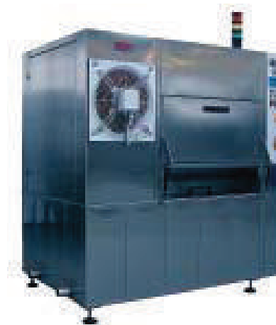
Rys. 2. Myjka komorowa natryskowo-zanurzeniowa typu KMPN 100Z ładowana ręcznie – konstrukcja objęta ochroną patentową.
